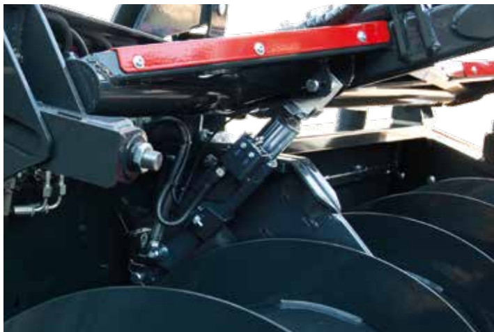
Siłownik hydrauliczny od regulacji wysokości nagarniacza
